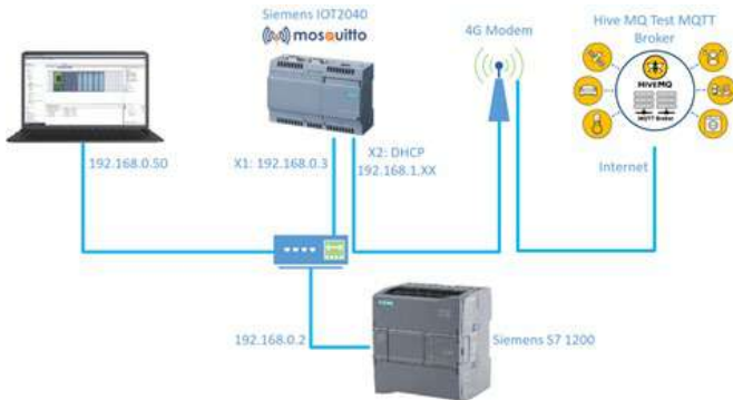
Abbildung 9: Netzwerkübersicht der S7-1200, Siemens IOT 2040, 5G-Modem und dem internetbasierten Hive MQ Test MQTT Broker.
